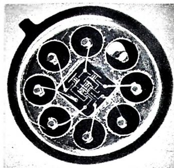
Bild 6. Vergrößerte Ansicht eines auf einem Transistorsockel untergebrachten Micrologic-Elements
